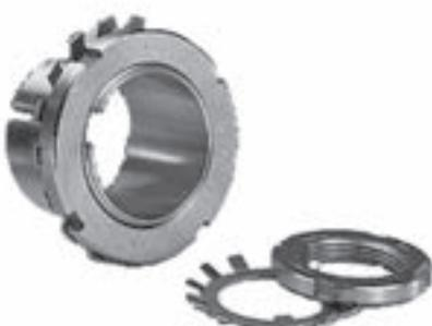
ベアリングを軸（シャフト）に平行に固定する一般的なものである。（アダプタ）ワッシャは、回転時におけるベアリングなどの振動からナットが緩まない様にベアリングとナットの間に取付けられる。
