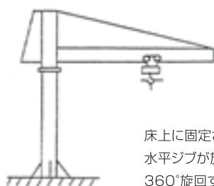
床上に固定された自立形の柱を中心に水平ジブが旋回する。
