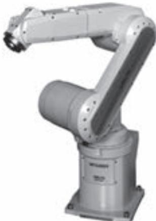
自律的に人間の代わりに作業を行う機械装置。産業ロボットとも呼ばれ、主に工場などの生産ラインで力が必要な作業や、危険な環境下での機械関係の点検・保守作業など、人間に比べて肉体的負担の大きい労働環境で使用されることが多い。(自動車や電子部分を生産する工場など)また、工場全体をロボット化して最低限の要員のみで運営している事例もあり、このような工場の自動化をファクトリーオートメーション(FA)と呼ぶ。
