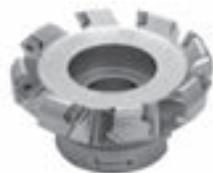
アダプタまたはアーバーを使って、フライス盤の主軸に直接取り付ける。刃先に超硬スロアウエイチップを取り付け、さまざまな切削加工を行う。
